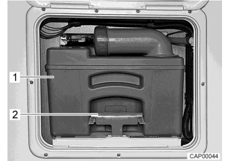
Fig. 106 Réservoir pour matières fécales
