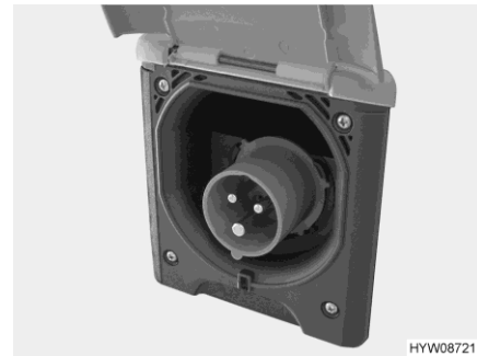
Fig. 69 Raccordement 230 V sur le véhicule (prise de courant CEE)
