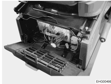
Fig. 65 Ubicazione centralina elettrica
