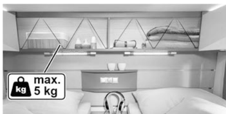
Afb. 51: Hangkasten in het slaapgedeelte
