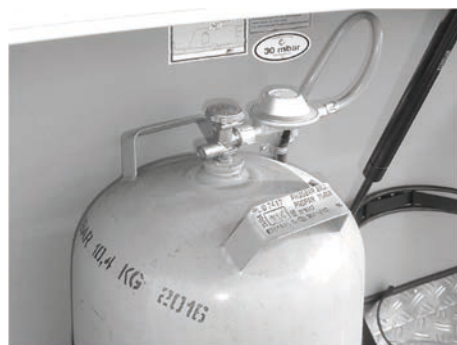
Afb. 68: Gasfles met lagedrukregelaar en lagedrukslang
