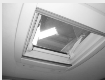
Bild 35: Takkåpa 400x400 mm VisionStar 700x500 mm
