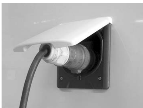
Bild 60: Anslutning till elnätet
