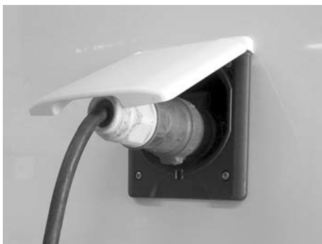
Bild 2: Anslutning till elnätet
