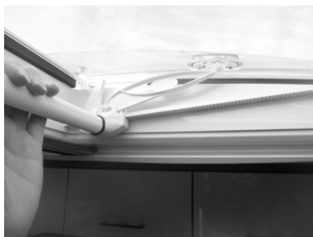
Bild 114: Manövrera takkåpa 400x400 mm / VisionStar 700x500 mm
