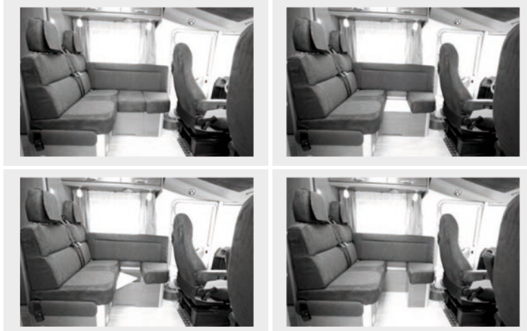
Bild 11: Ombyggnad av L-sittbänken till en sittrad för passagerare
