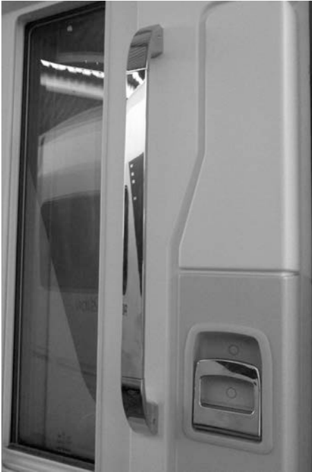
Bild 18: Invändig dörr med greppstång och greppbygel
