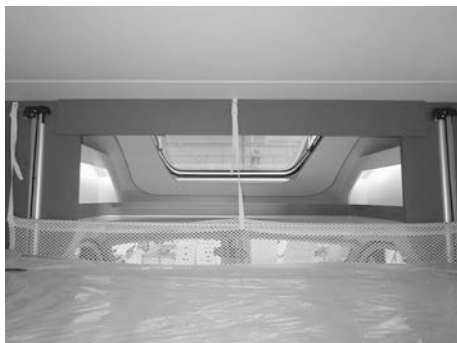
Bild 167: Sänkt lyftsäng med utfallsskydd
