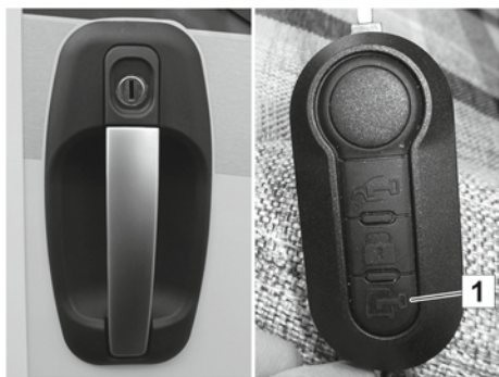
Bild 10: Dörrhandtag, nyckel med fjärrkontroll för centrallåset
