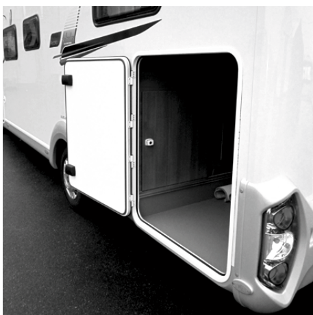
Bild 19: Boendedel, servicefack på utsidan, exempel: Litet förvaringsfack för ofta använda fordons- eller resetillbehör
