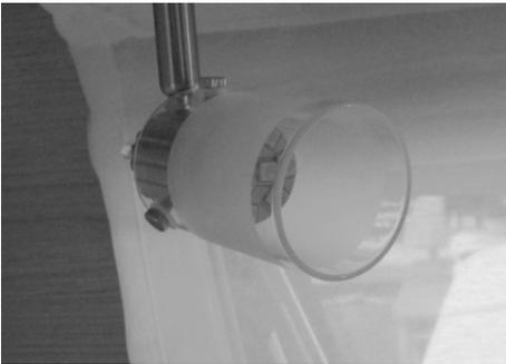
À l'intérieur, au-dessus du groupe de sièges et dans la chambre, des spots LED 12 V mobiles, inclinables et pivotants disposés sur un système de rail assurent un bon éclairage des différentes places (procédure à suivre → section « Réglage de l'éclairage »).
