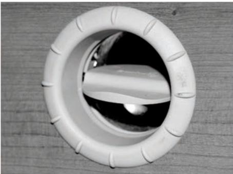
Pour le chauffage de la cellule, la soufflerie du chauffage à gaz achemine l'air chaud jusqu'aux buses d'air chaud de l'habitacle par un système de conduites d'air chaud.
