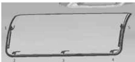
Fig. 31: Vue intérieure de la baie ouvrante galbée à cinq poignées de verrouillage
