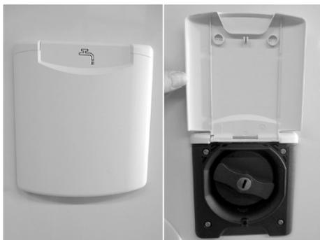
Fig. 21 : Manchon de remplissage d'eau fraîche
