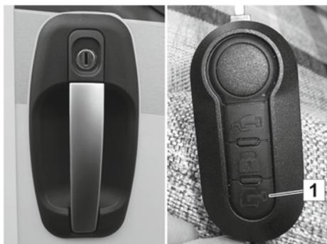
Fig. 10 : Levier de porte, clé avec télécommande pour le verrouillage centralisé
