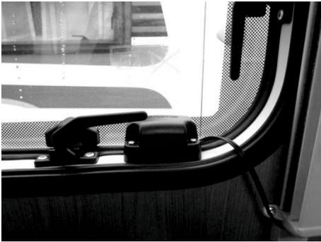
Fig. 84: Interrupteur de vitre
