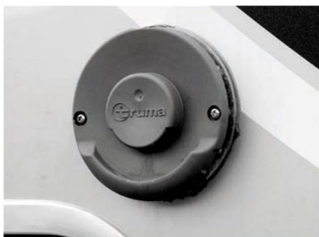
Fig. 80: Conduit d'évacuation des gaz brûlés (sur la paroi)
