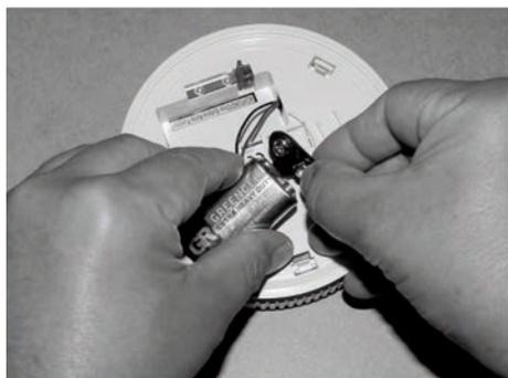
Fig. 203: Remplacer la pile
