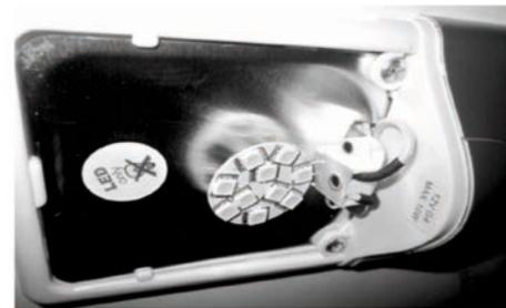
Fig. 194 : Introduire l'ampoule LED
