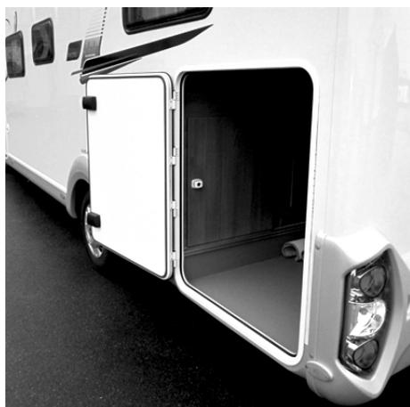
Sur les côtés extérieurs du camping-car - suivant le modèle et le niveau d'équipement choisis - on trouve des trappes correspondant à divers casiers de service, par ex. accès au garage arrière/espace de rangement arrière, chauffe-eau, petit casier de rangement (pour accessoires du véhicule, outillage, cric) et à la cassette WC des toilettes.
