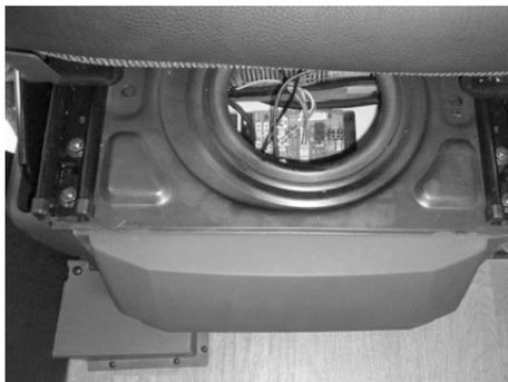
Fig. 7 : Module d'interface sous le siège du conducteur
