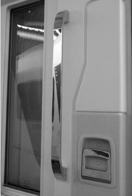
*Fig. 18 : Porte intérieure avec poignée et étrier de poignée*
