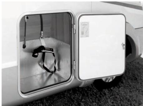
Fig. 70: Exemple de caisson à gaz
