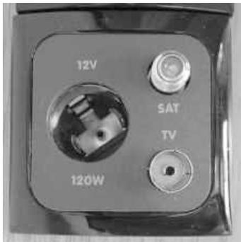
Lorsque le support mural pour TV est monté, une prise de courant 12 V est également configurée pour le fonctionnement alternatif du téléviseur.
