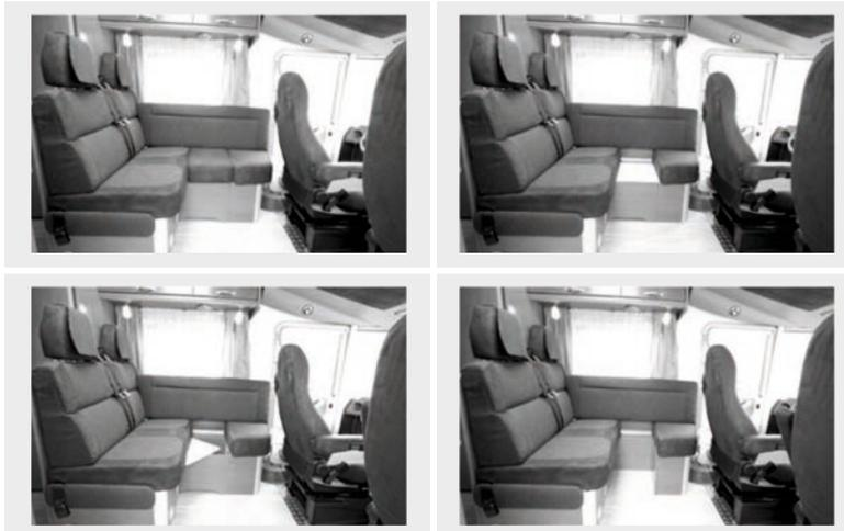
Fig. 11: Transformation de la banquette en L en une rangée de sièges pour les passagers
