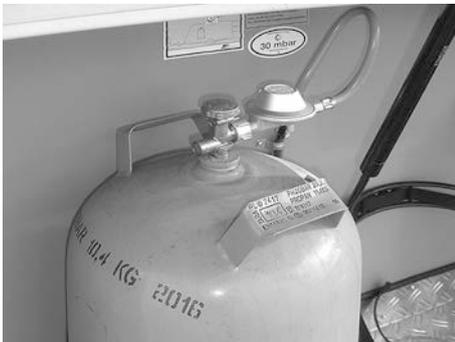
Fig. 106: Bouteille de gaz avec détendeur
