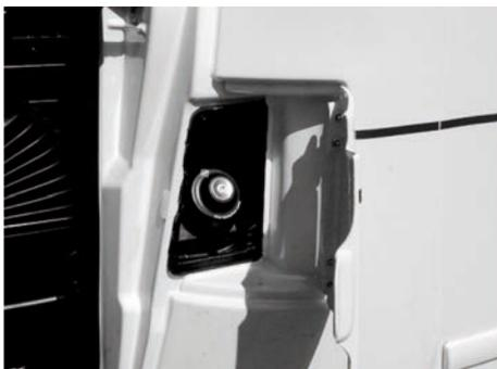
Fig. 9 : Exemple de bouchon de réservoir de carburant
