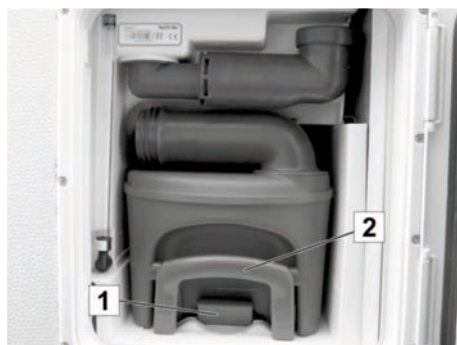
Fig. 192 : Cassette WC dans le puisard d'élimination
