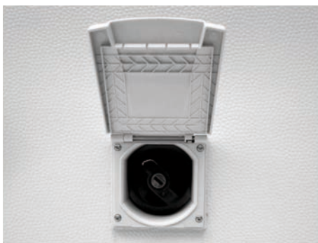
Fig. 88: Manchon de remplissage d'eau fraîche
