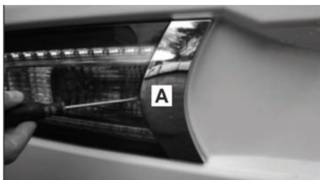
Fig. 223 : Support de l'éclairage arrière
