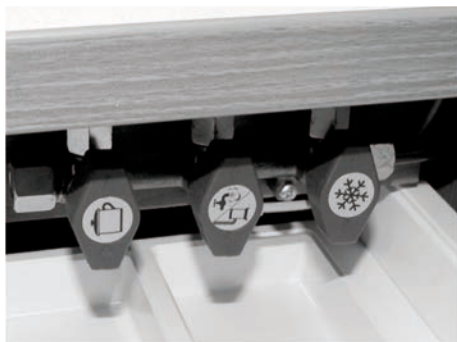
Fig. 73: Vannes d'arrêt rapides
